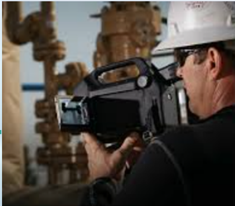
Methane Leak Detection and Repair / Detección y reparación de fugas de metano
